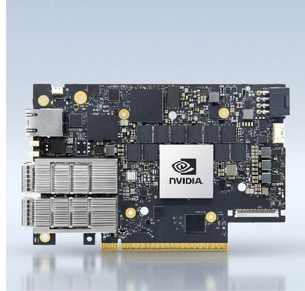
NVIDIA® BlueField®-3 DPU（数据处理器）是第三代基础设施计算平台，使企业能够构建从云到核心数据中心再到边缘的软件定义、硬件加速的 IT 基础设施。借助 400Gb/s 以太网或 NDR 400Gb/s InfiniBand 网络连接，BlueField-3 DPU 可以卸载、加速和隔离软件定义的网络、存储、安全和管理功能，从而显著提高数据中心的性能、效率和安全性。
